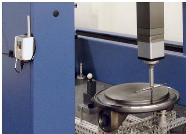
Monitoraggio delle condizioni ambiente in una sala metrologica con un data logger testo Saveris
